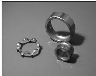
Aussenring, Innenring und Käfighälften werden im zerlegten Zustand einzeln beschichtet
